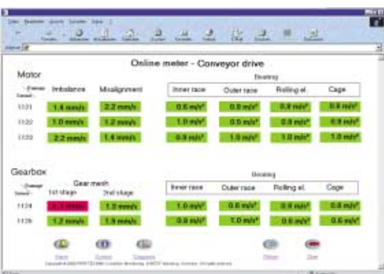
Fig. 5: Kundenspecifika bilder i sökmotorn (tillval): där en färgkodad översiktsbild alltid visar maskinens nuvarande status och eventuella problem.
